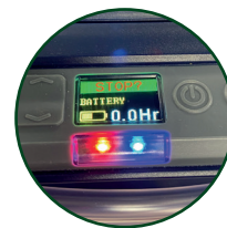
Display OLED colore pieno con LED rosso/blu che indica lo stato della pompa, visibile a distanza
